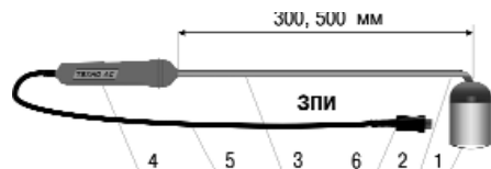
Рис.7б Зонд поверхностный изогнутый (ЗПИ)
