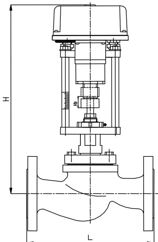
Рисунок 1. Габаритные установочные и присоединительные размеры клапана.
