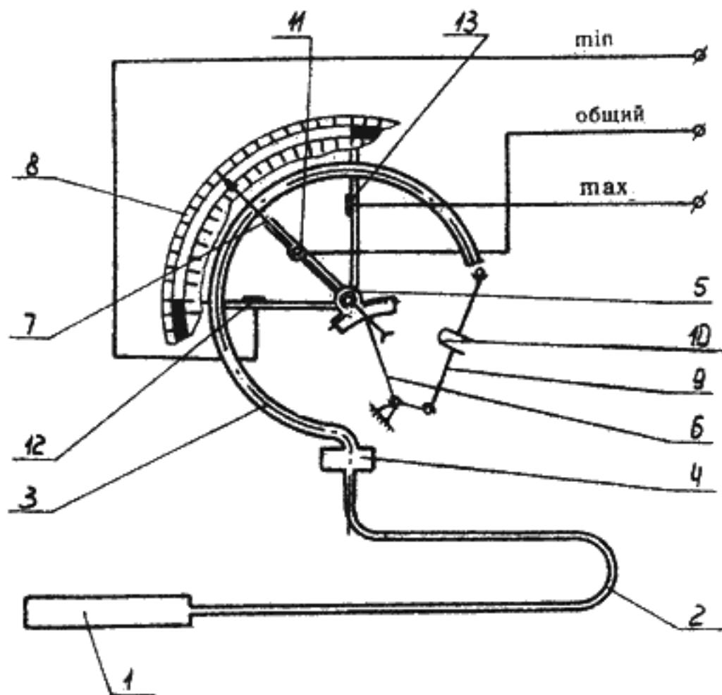
1 – термобаллон; 2 – соединительный капилляр; 3 – манометрическая пружина; 4 – держатель; 5 – трибка; 6 – сектор; 7 – стрелка; 8 – циферблат; 9 – тяга; 10 – биметаллическая скоба (для ТГП-100Эк-М1); 11 – ведущий поводок; 12 – контакт «минимум»; 13 – контакт «максимум».
