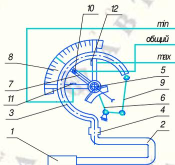
1 – термобаллон; 2 – соединительный капилляр; 3 – манометрическая пружина; 4 – держатель; 5 – ось; 6 – сектор; 7 – стрелка; 8 – циферблат; 9 – тяга; 10 – ведущий поводок; 11 – контакт «минимум»; 12 – контакт «максимум».
