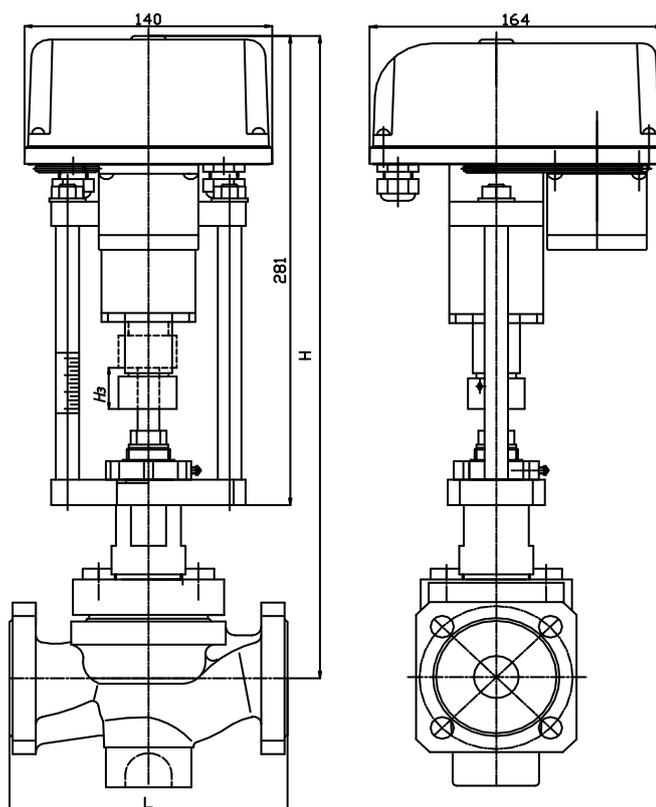
Рисунок 1. Габаритные установочные и присоединительные размеры клапана.
