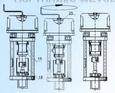
Отвинтить стакан (18) и освободить доступ к стопорным винтам упорных гаек (15),
