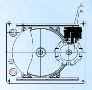
Снять диск прерывания (16) с оси вала двигателя (8), для чего необходимо снять совместно с кронштейном датчик вращения (3), отвернув винты его крепления к плите(30).
