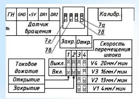
скоростей Переключение перемещения производится переключателями, установленными плате модуля привода в соответствии со схемой переключений, приведенной на табличке. Набором комбинаций переключения двух переключателей 7а и 76 осуществляется выбор значений скорости одного ИЗ четырех перемещения выходного органа механизма. Для выбора необходимой требуется скорости установить переключатели в соответствии с рисунком.
