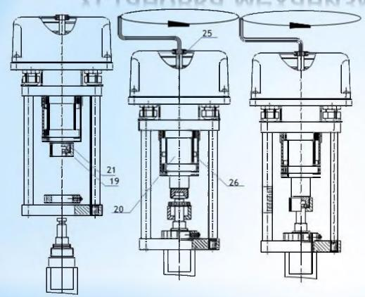
При установке механизма на арматуру, затвор последней должен находиться в закрытом состоянии.
