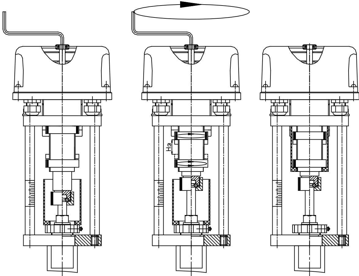
Рисунок 4 Порядок настройки механизма на условный ход.
