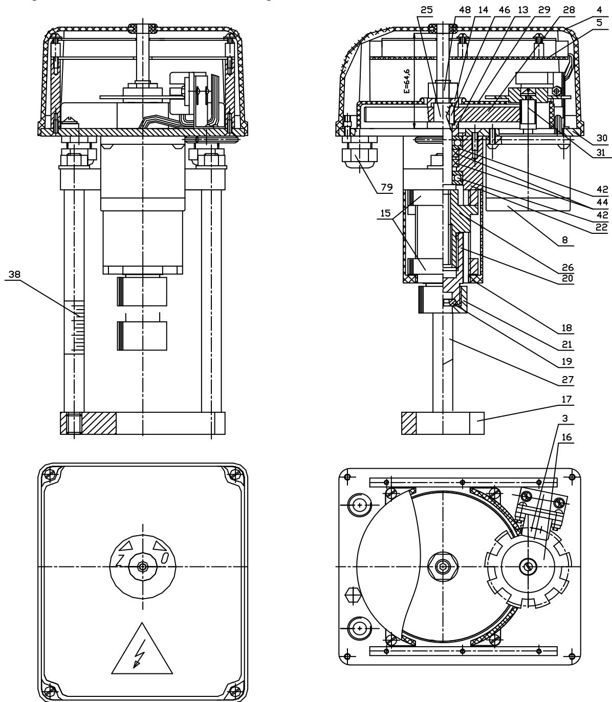
Рисунок 1 Устройство исполнительного механизма МЭП-3500/ХХ-30-Б-Ф-57-35-ХХ
