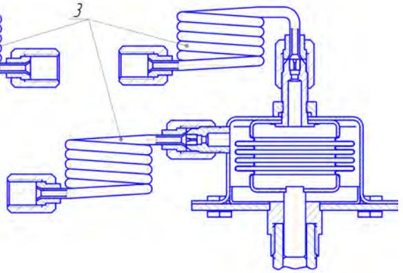
Рис. 3 Регулятор давления РДС-НЗ
