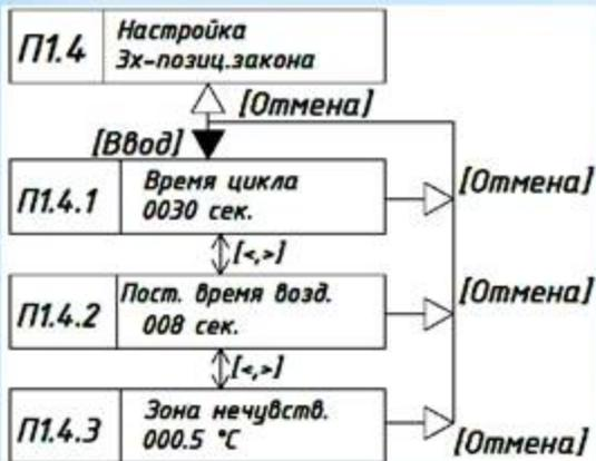
Настройка параметров 3х-позиционного закона регулирования производится через вход окном *P1.4*. После входа в подсистему меню настройки параметров 3х-позиционного закона на ЖКИ выводится окно *P1.4.1*. Перемещение по окнам *P1.4.2* и *P1.4.3* производится клавишами “Больше”, “Меньше”, выбор определенного окна с целью редактирования параметра производится нажатием клавиши “Ввод”. Редактирование параметров производится аналогично вышеописанным случаям.
