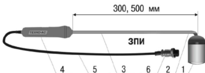
Рис. А2 Зонд поверхностный изогнутый (ЗПИ.8)
