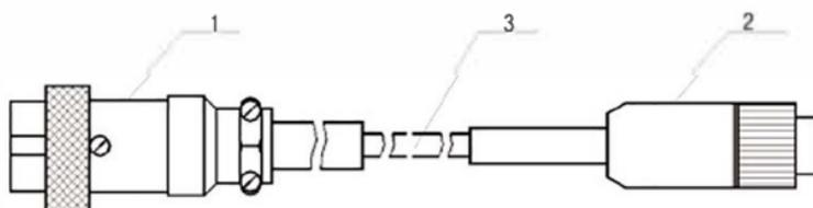
Рис.Б.2 Кабель удлинительный для ЗВЛМ
